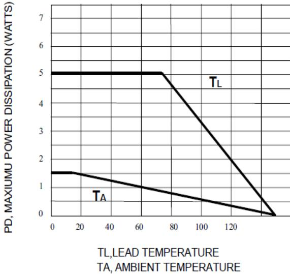
Fig. 1-POWER TEMPERATURE DERATING CURVE
