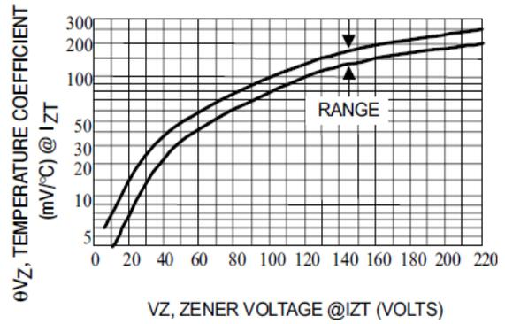
Fig. 2-TEMPERATURE COEFFICIENT-RANGE FOR UNITS 6 TO 51 VOLTS
